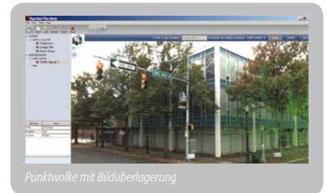
Punktwolke mit Bildüberlagerung
